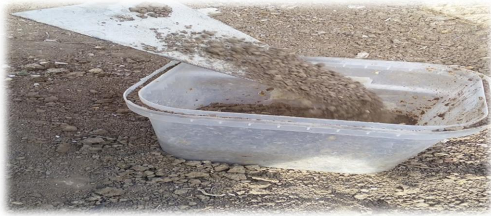
Figure 5 : échantillonnage du sol
